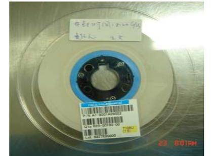
图二B开封后注明开封时间与责任人贴于滚轮上
